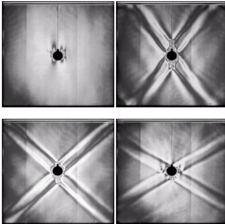
Figure 1: Champs d'ondes produits par un cylindre oscillant au centre d'une cuve rectangulaire remplie d'un fluide stratifié en densité et dont la fréquence de Brünt-Väisälä est  $N^{-1} = 4s$ . a) Etat initial, b)  $\omega^{-1} = 3.8s$ , c)  $\omega^{-1} = 5s$ , et d)  $\omega^{-1} = 8s$ .
