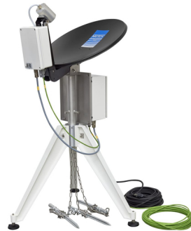
FIGURE 1.4 – Micro Rain Radar (MRR) METEK installé à Dumont D'Urville
