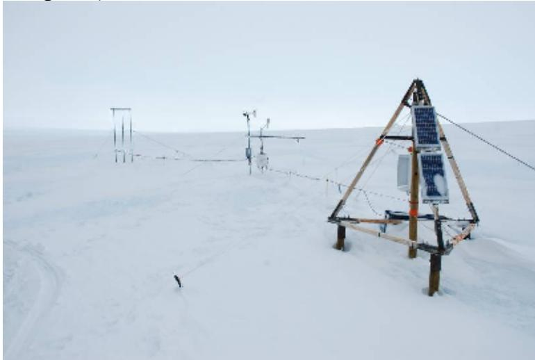
**Figure 7 : la station de D3 avec le portique FlowCapt au 3ème plan (Trouvilliez, 2010)**
