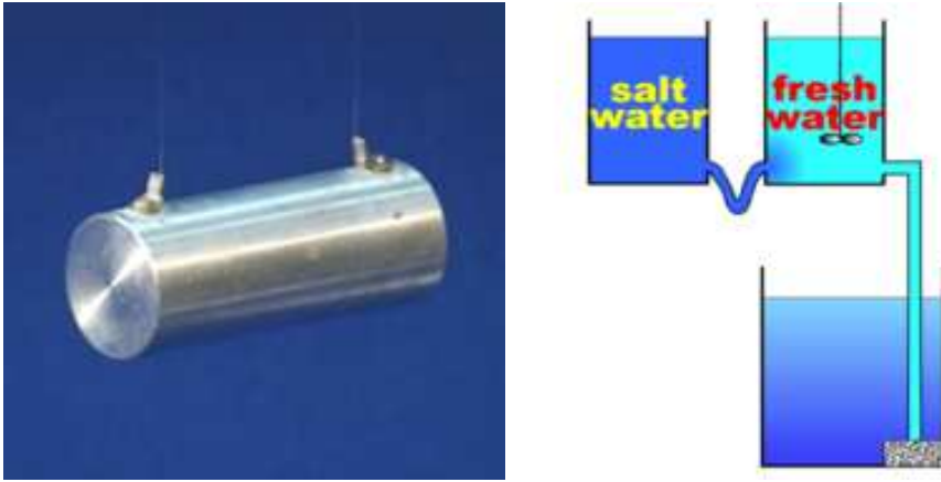
Figure 1: Protocole expérimentale pour l'étude des ondes internes de gravité produites par une source fixe oscillant à une fréquence \omega . a) cylindre oscillant verticalement, b) pour produire la stratification on mélange continuellement de l'eau salée avec de l'eau pure, et on injecte progressivement le mélange par le bas de la cuve. Au cours du temps, la fraction d'eau salée dans le mélange augmente, ce qui crée la stratification stable en densité.
