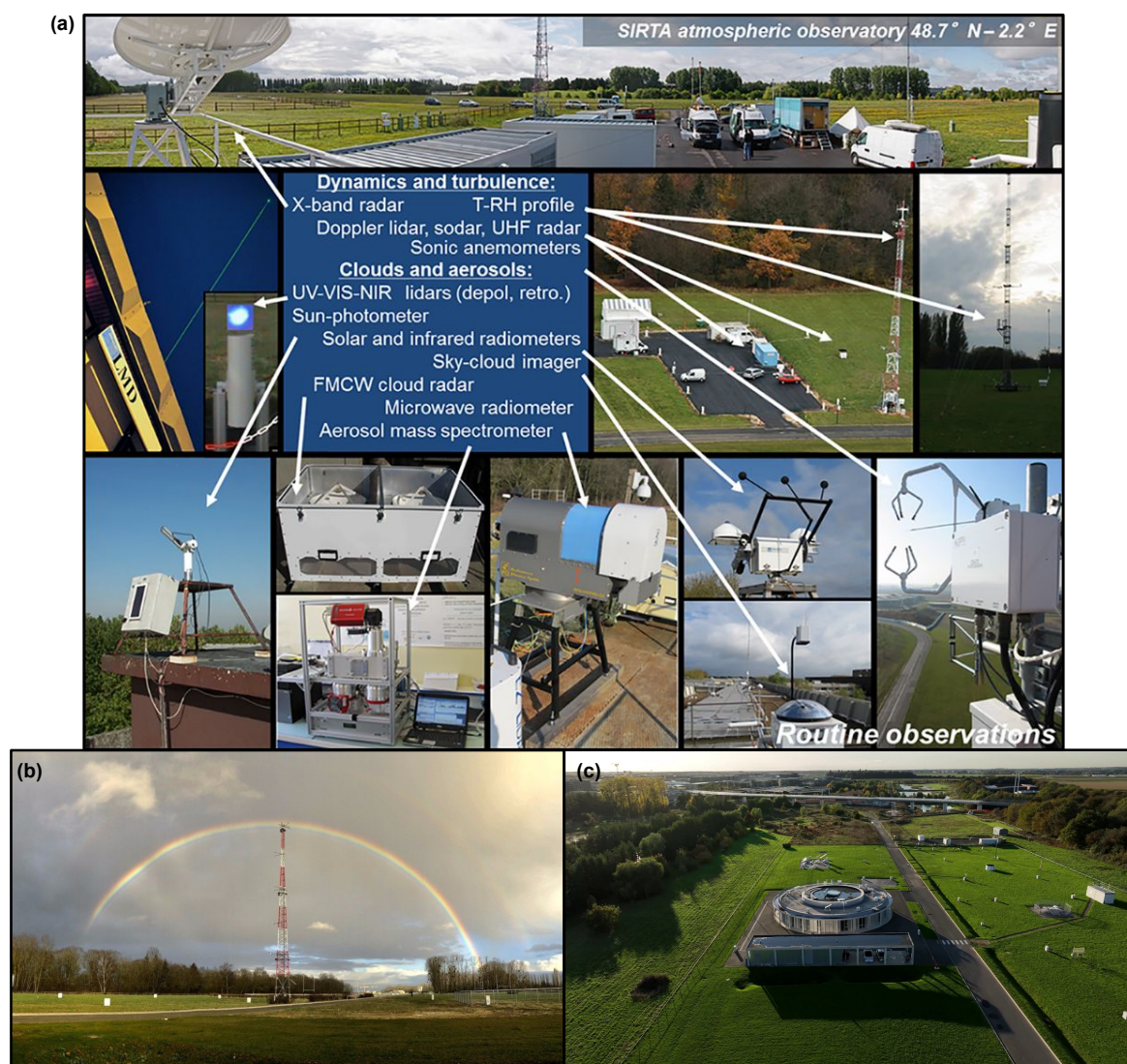
FIGURE I.3 – (a) Figure issue de Chiriaco et al. (2018) montrant une partie des instruments du SIRTa avant son déménagement. (b) Mât de mesure météorologique actuel de 50 m (IPSL/SIRTa, sd) (c) Etat du site actuel, une partie des instruments sont désormais posés sur le toit du bâtiment (IPSL/SIRTa, sd)
