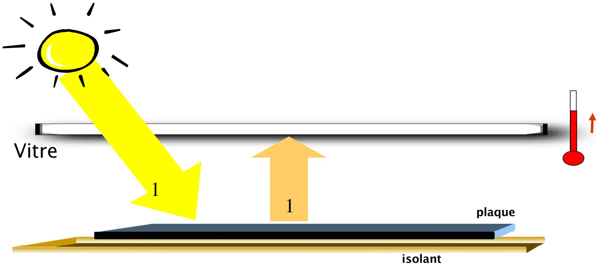
L'absorption par la vitre du rayonnement infrarouge émis par la plaque lui fait gagner de l'énergie donc sa température s'élève.
