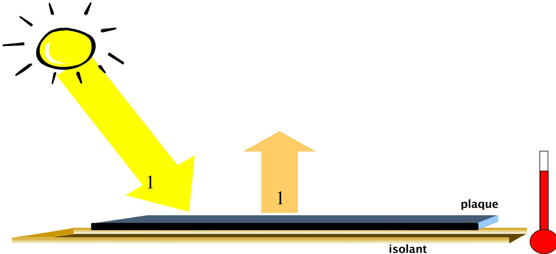
c) Finalement elle atteint sa température d'équilibre lorsqu'elle perd autant d'énergie par émission de rayonnement infrarouge qu'elle en gagne par absorption de rayonnement solaire.
