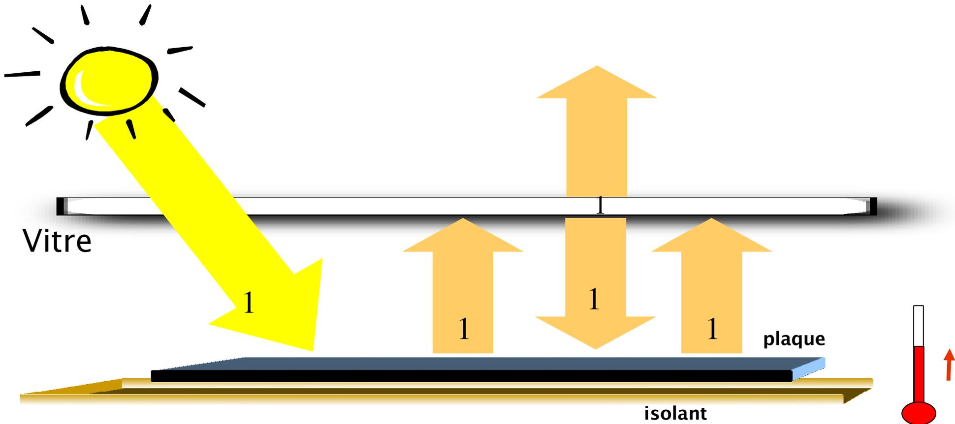
on retient que placer une vitre au dessus d'une plaque au soleil a pour effet de «piéger» le rayonnement infrarouge émis par la plaque, et donc d'augmenter sa température.
