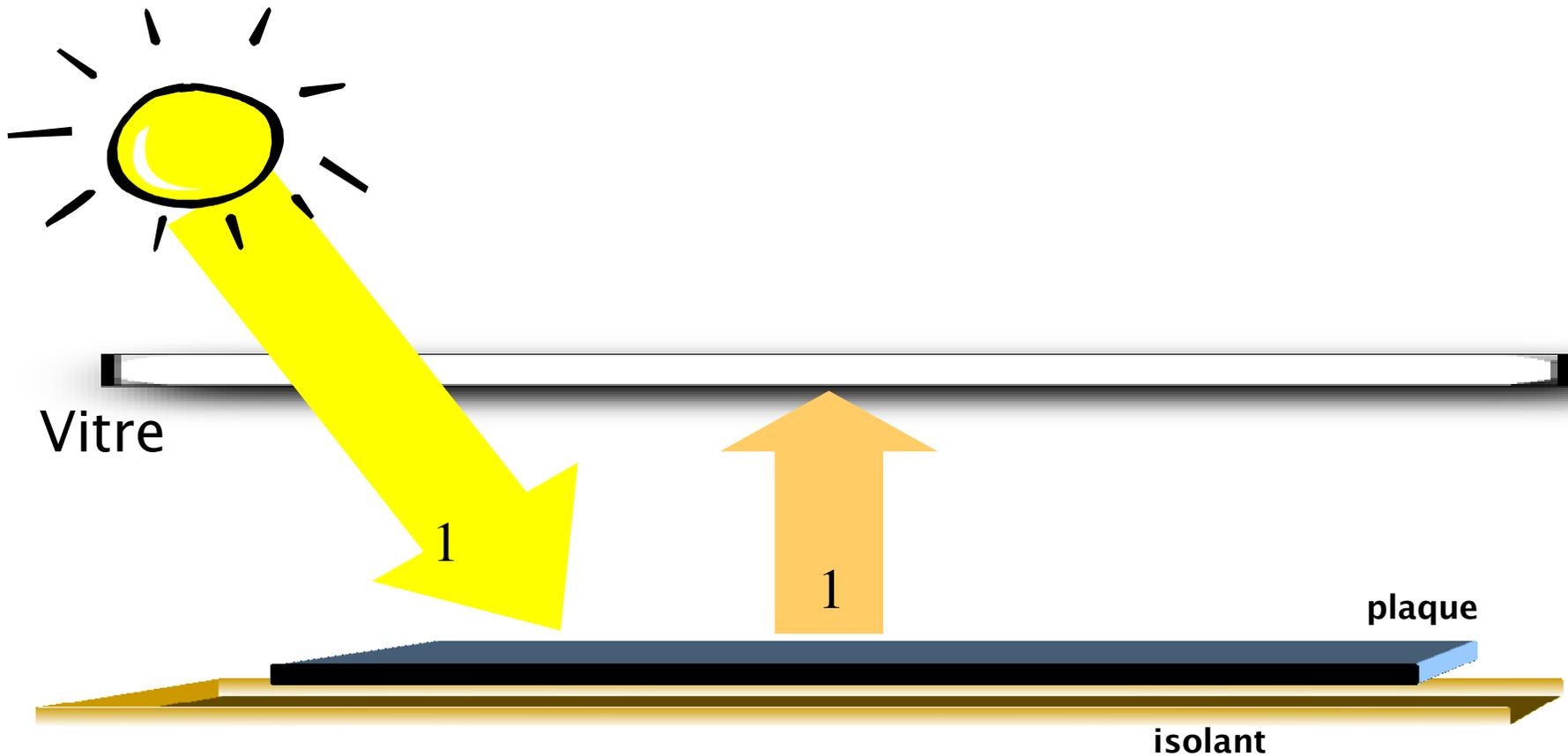
Plaçons maintenant une vitre au-dessus de cette plaque au soleil. Cette vitre est parfaitement transparente au rayonnement solaire mais absorbe totalement le rayonnement infrarouge.
