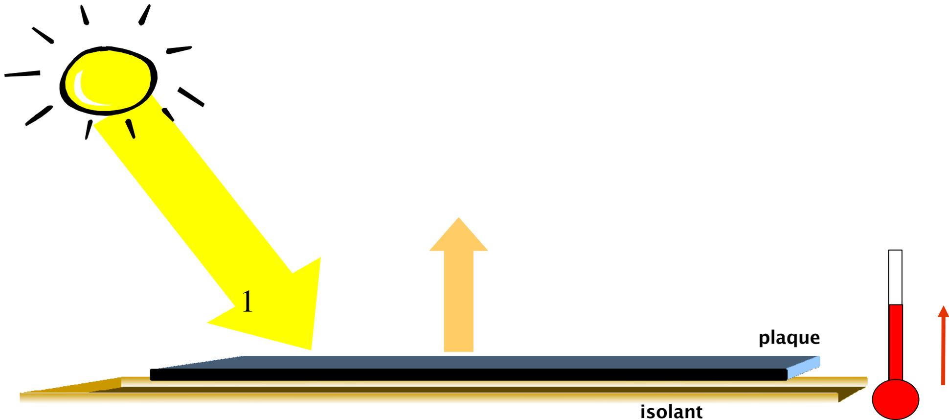
b) Comme elle gagne de l'énergie sa température augmente. Comme sa température augmente, l'énergie perdue par émission de rayonnement augmente.
