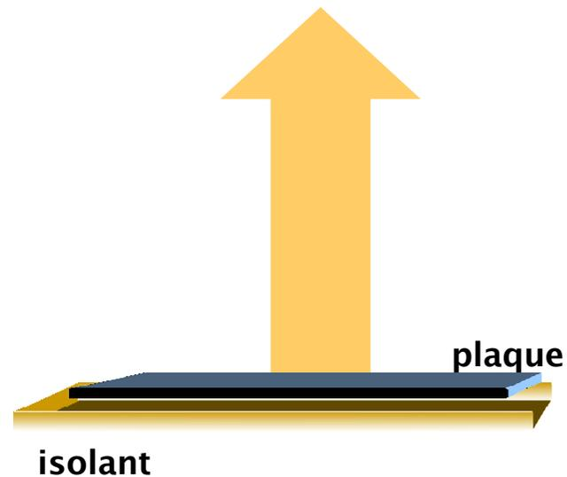
*a) Tout corps (ici une plaque posée sur un isolant thermique) émet du rayonnement et ainsi perd de l'énergie*
