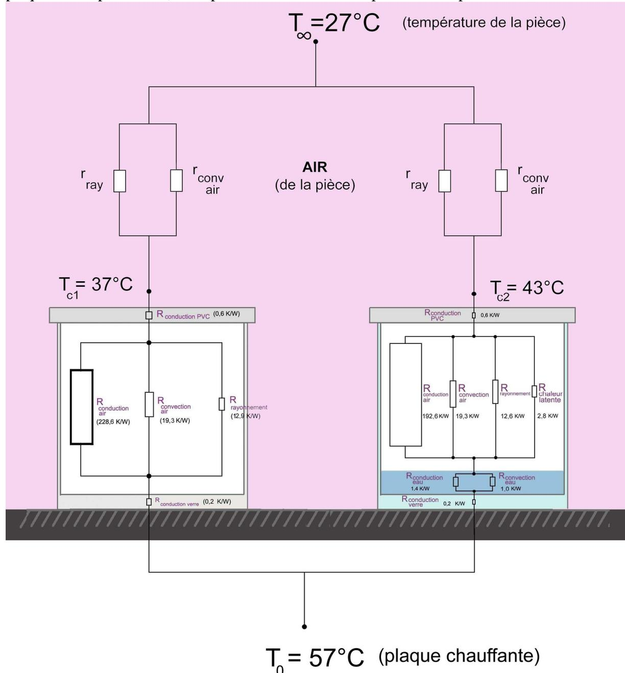
On associe à l'air de la pièce 2 résistances : une de convection et une de rayonnement, puisqu'on a vu précédemment que la conduction de la chaleur dans l'air est très faible par rapport à ces 2 modes de transfert.
