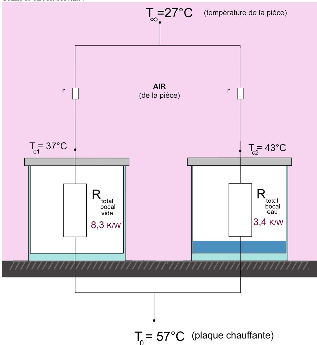
On a appelé  $T_{c1}$  et  $T_{c2}$  les températures des couvercles.
