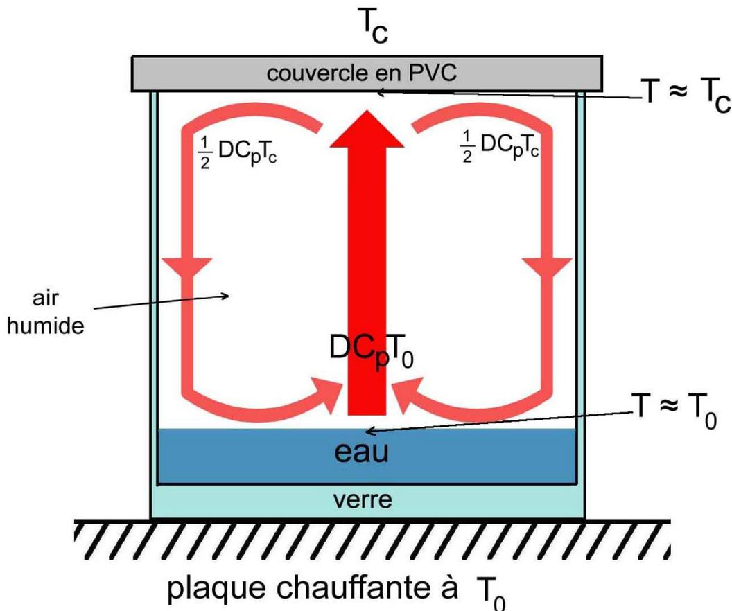
On suppose que toute l'eau liquide est à la même température que la plaque  $T_0$ , et que la température du couvercle vaut  $T_c$  en tout point.
