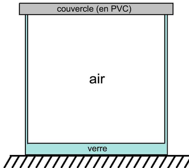
Entre la plaque chauffante à la température  $T_0$ , et le sommet du couvercle à la température  $T_c$ , le flux de chaleur va traverser d'abord le verre, puis l'air et enfin le couvercle (choisi en plastique).
