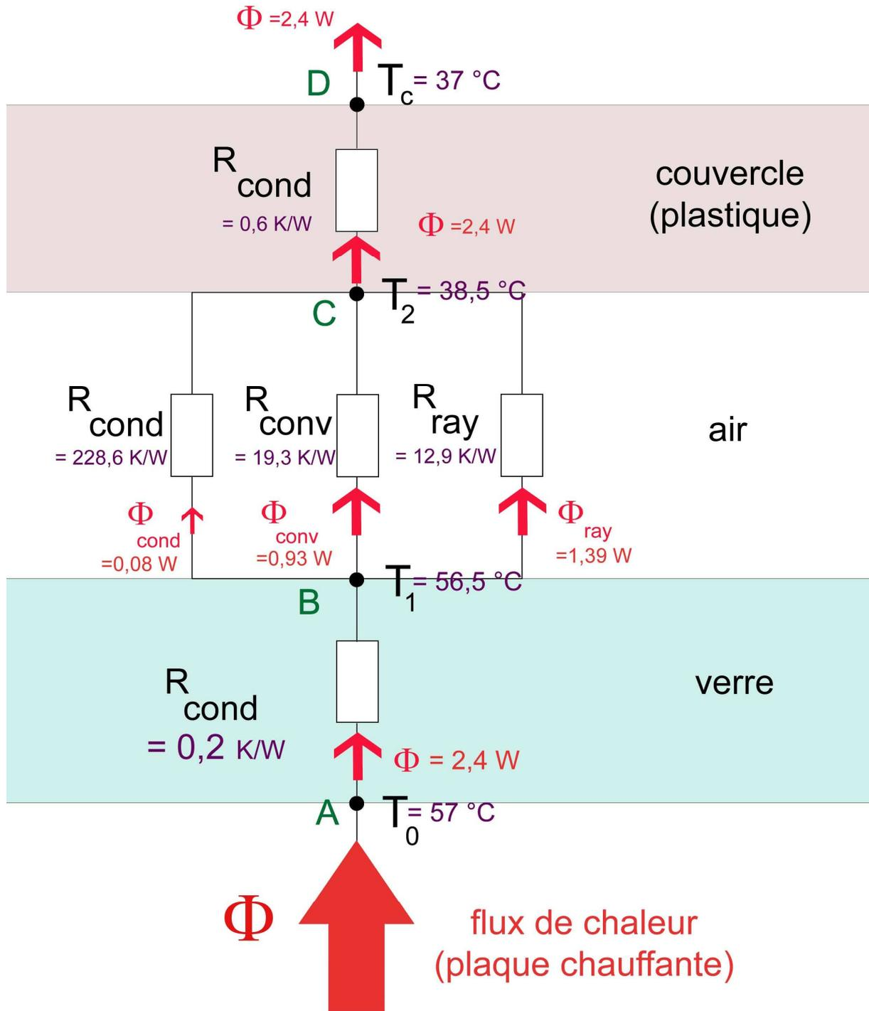
Le circuit devient, avec la résistance équivalente aux 3 différentes résistances de l'air :
